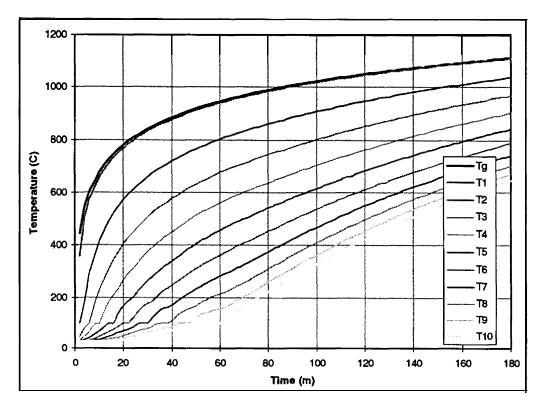
FIGURE 7. STEEL DUCT INSULATION TEMPERATURES
